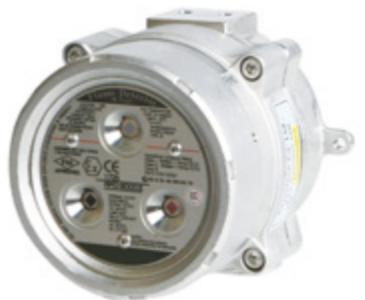
Visokokvalitetni detektori plamena s 3IR i UV/IR tehnologijom proizvođača Atexon® odlikuju se visokom otpornošću na sunčevu svjetlost, elektrolučno zavarivanje i ostale vrste svjetla, što ih čini prikladnim za strojeve i benzinske postaje. Ti detektori plamena mogu se ugraditi u baterijski sustav za otkrivanje i gašenje iskri Atexon®.
